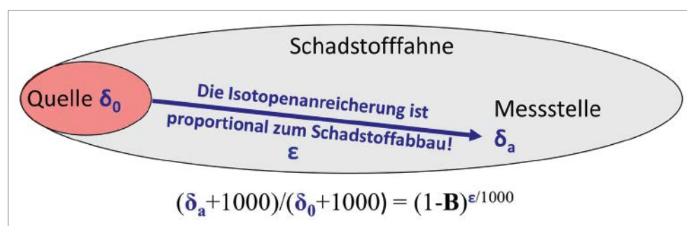
Abbildung 2: Abbauquantifizierung (prozentualer Schadstoffabbau B) im Abstrom einer Schadstoffquelle anhand von Isotopenwerten ( \delta_0 , \delta_{\text{abstromig}} ) und dem Isotopenanreicherungsfaktor ( \epsilon ).
